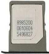
6. Deslice suavemente la bandeja de la tarjeta en la ranura de la tarjeta SIM y cierre la cubierta de goma.
